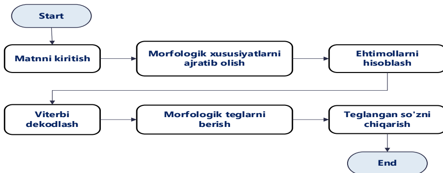
3-rasm. Statistik modellar (HMM, CRF va boshqalar) asosida morfologik tahlil qilish jarayonlar ketma-ketligi.
